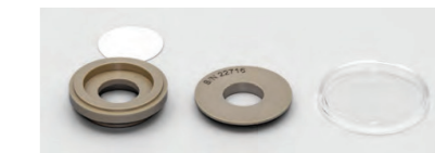
按压式盖帽组件包括序列化的扩散池瓶盖和具有精密孔径的剂量室。
