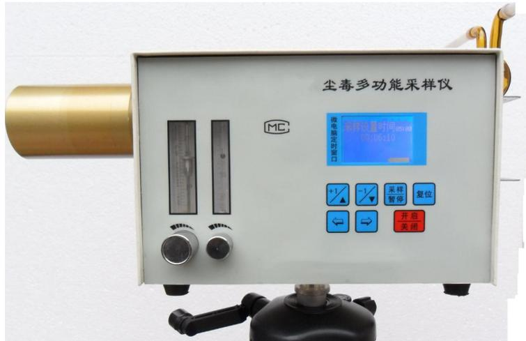
LB-3CD 型尘毒多用采样仪是汲取国内外同行先进技术，符合我国通用的滤膜称重测尘方法研制生产的新产品，该仪器技术先进，性能可靠，携带方便、测定准确，具有安全防爆等级，同时测量大气中各种有害粉尘及气体等物质排放浓度的理想仪器。
