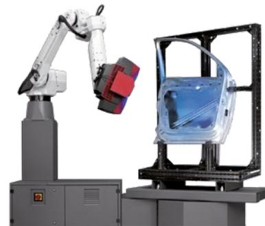
**测量评估** – 采集数据之后，软件计算出部件表面的多边形网格以及检测元素计划的相关实际值。实际数据跟标称数据进行比较，显示在报告中。测量结果自动保存为特殊的输出格式，比如统计质量控制的数据库。不同部件的测量流程均可完全自动执行。
