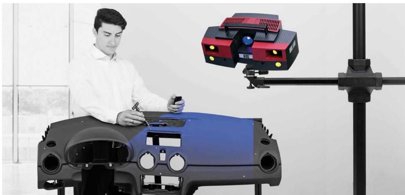
ATOS Triple Scan是一款高分辨率的光学扫描仪，可快速提供精确的三维测量数据，以优化设计过程、改善工业生产流程。许多行业领域都采用ATOS测量头，检测例如钣金件、工模具、涡轮叶片、原型、注塑件以及压铸件等零部件。
