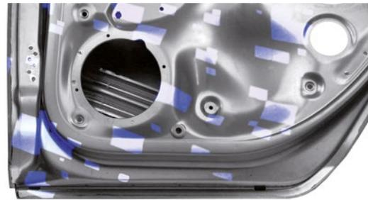
**系列测量** – 即用型测量程序可应用于系列部件的检测。机器人由软件完全控制，并依次运行到各个测量位置。每次测量时均检查其结果是否符合质量标准。由于软件的性能化性能，CAD数据状态的更改或测量计划的变化可被快速更新。
