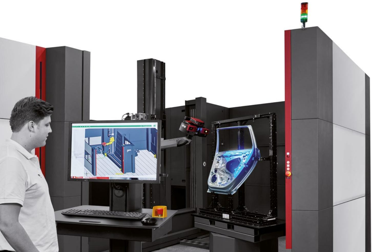
**检测计划** – CAD数据集跟相关的测量计划一起被输入。出自测量计划的检测元素自动从测量计划获得相关测量原理。另外还可提前离线准备测量报告。测量流程结束之后，可随即显示实际测量结果。
