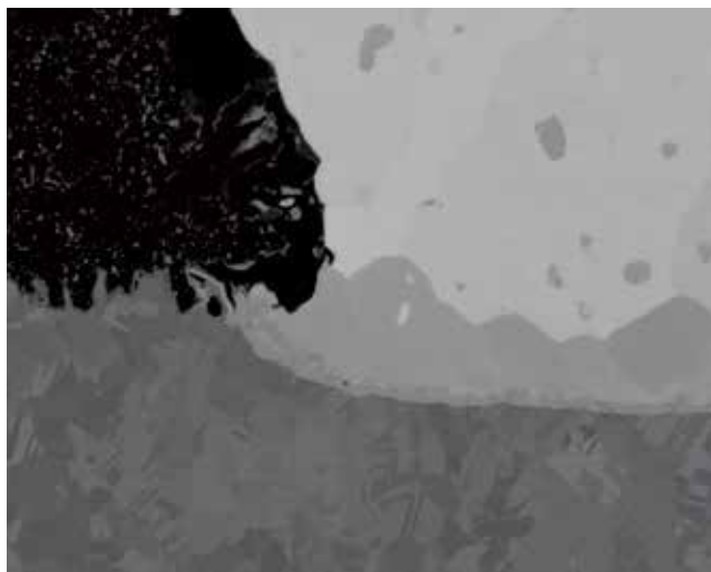
焊球, 经离子束抛光, SEM图像
