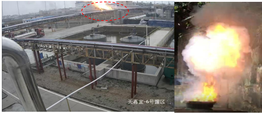
图2 硝化废料燃烧特征对比
