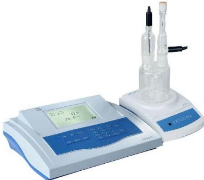
KLS-411 型微量水分分析仪适用于微量液体样品的测定，常用于测量含水量较低的样品。
