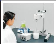
● 粉体的造粒、干燥、混合 医药品、食品、催化剂、燃料、洗涤剂、陶瓷等 因为适用于50~300g左右的试料,所以最适合高 价试料或研究层次的实验。
