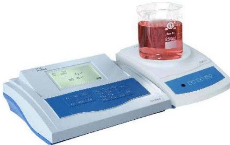
ZDY-500 型自动永停滴定仪适用于重氮化测法测定终点指示和其它需用永停滴定法的试验。注意，这些反应必须是如下类型的：终点前，电极上电流很小；到终点后，产生较大的电流突跃。
