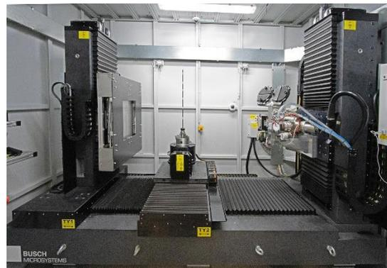
图1 系统内部的大理石结构
