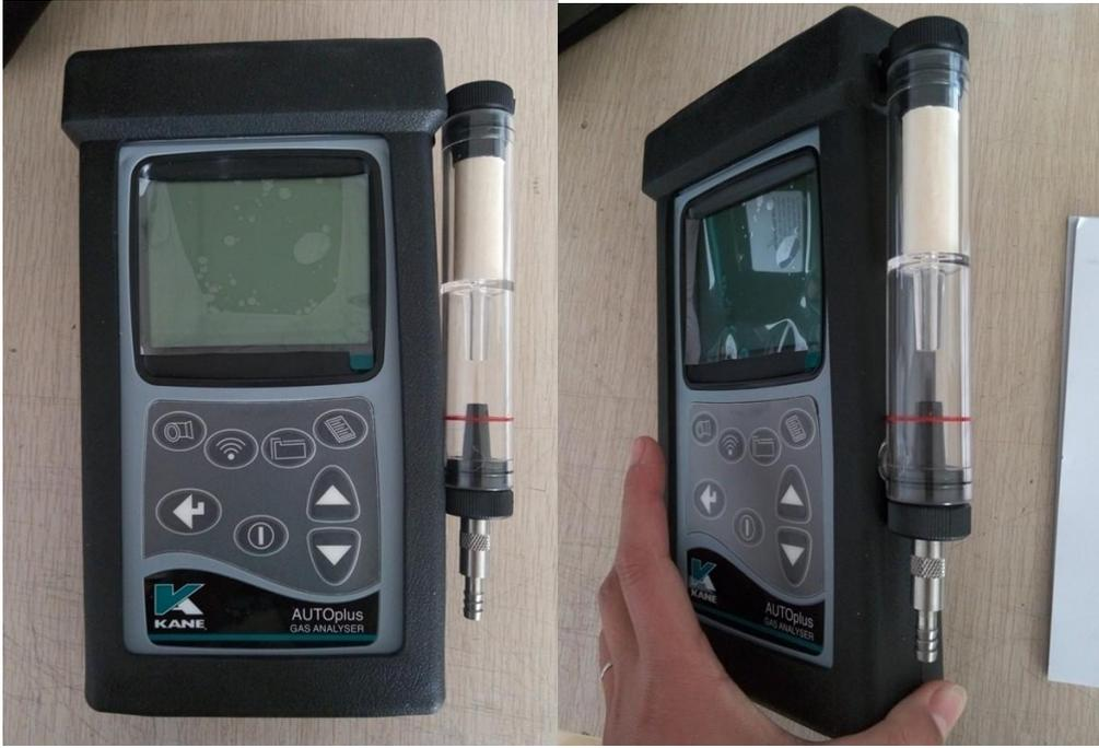
手持式五组份汽车尾气分析仪同时测量：CO, HC, O<sub>2</sub>, CO<sub>2</sub>, NO, 机油温度, 发动机转速.
