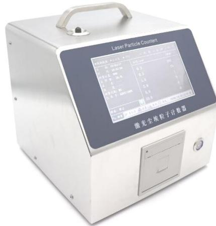
CLJ-320 大流量尘埃粒子计数器是一款新型的尘埃粒子计数器，用于测量洁净环境中单位体积空气内的尘埃粒子大小及数目，能够快速验证洁净室的洁净度等级及打印出相关的测试结果，完全符合 ISO14644 及 2010 版 GMP 的标准。该产品采用了非常友好的用户界面，高分辨率大尺寸彩色触摸屏幕，操作方便，简单易用。同时这款仪器能同步监测 6 个粒径通道的粒子数目及其变化情况，存储数据 1000 组。广泛应用于洁净厂房的颗粒物测试、空气粒子研究、室内空气质量评估，也用于过滤器性能测试及洁净度评价等。
