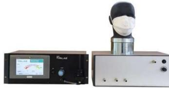
使用前将面罩放在测试头部上。使用高分辨率气溶胶光谱仪，空气中颗粒污染物（尺寸和污染物）均可被检测到。设备自动切换后并确定口罩过滤后的微粒污染。这可以自动重复数次。两个测量值间的比率用于确定口罩的防护等级。快速确定口罩是否可用。
