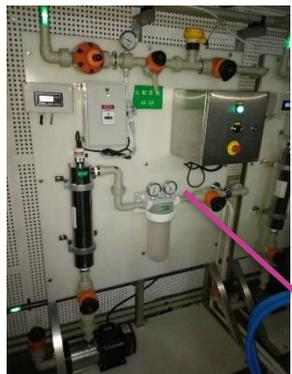
所有的部件集成于机柜内,包括纯水储罐和控制系统
