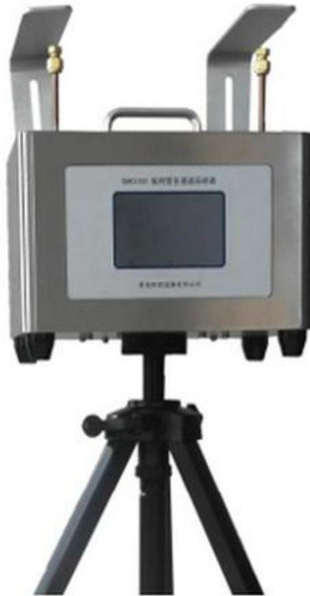
RGK-300 便携式大气采样器主要应用于大气中挥发性有机化合物 (VOCs) 的采样。
