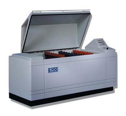
Q-FOG 循环腐蚀盐雾箱是一种用于人工模拟盐雾腐蚀环境的试验设备,可以用于模拟海洋性气候,用于考核材料、产品及其防护层的抗盐雾腐蚀的性能,以及评价防护层的工艺质量。与天然的环境相比较,盐雾腐蚀试验箱中的盐雾环境是自然条件下的几倍甚至几十倍,因此能够更加快速的得出自然环境下产品的耐盐雾腐蚀效果,能够在几天或者几个星期的时间内,获得户外产品几个月,甚至几年的腐蚀效果。
