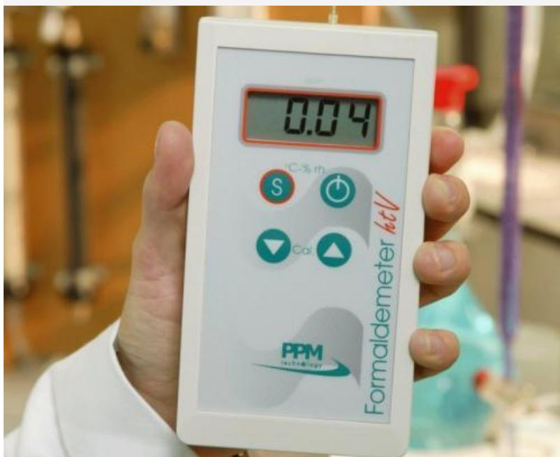
产品描述:英国 PPM-HTV 甲醛检测仪是一款国外原装进口型甲醛检测分析仪,检测量程是 0-10PPM,分辨率是 0.01PPM,精度在 10%以内。采用自己研发的电化学甲醛传感器,寿命更长,精度更高。甲醛浓度单位可在 ppm 与 mg/m<sup>3</sup> 之间自由转换。标配苯酚过滤器及甲醛校正源。10 秒出甲醛检测结果。广泛用于室内甲醛检测,装修房子后的甲醛浓度是否超标,及木材厂甲醛检测、家具 HCHO 浓度分析、C<sub>2</sub>H<sub>2</sub> 检测等。
