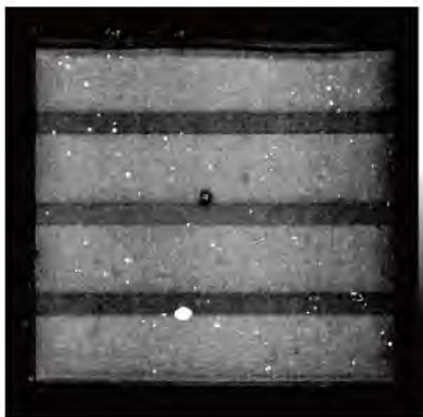
SMD 贴片电容超声扫描图像，图中白点为空洞缺陷
