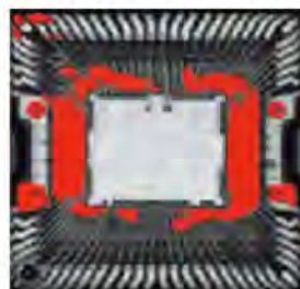
IC 内部的 C-扫描图像
