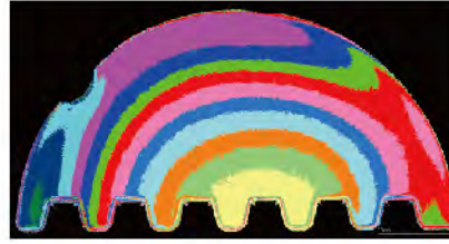
金刚石刀具涂层厚度 变化的检测 不同颜色显示出涂层 的厚度不同
