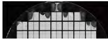
FOWLP 晶圆封装样品，这类 样品封装完成后会产生很大的 翘曲，使用HiSA和DTS模式 测试可以很好地解决这类翘曲 样品的检测。
