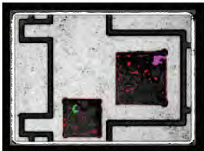
IGBT 样品芯片焊接 层 C-扫描图像，分 层缺陷根据其面积 大小，用不同颜色 着色
