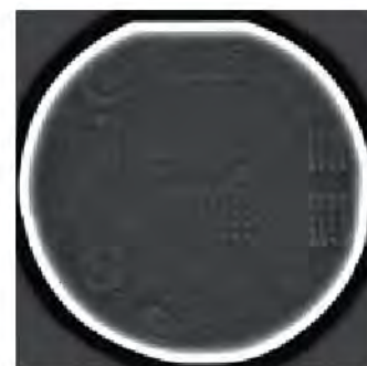
Bonded wafer, 对 bonding 界面进行 X-ray 观测
