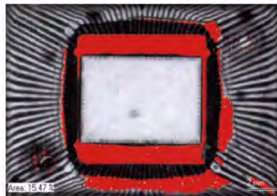
塑封 IC 半导体器件的检测，红色区域为分层缺陷，采用相位翻转检测后对缺陷位置着色，并计算出缺陷所占面积百分比
