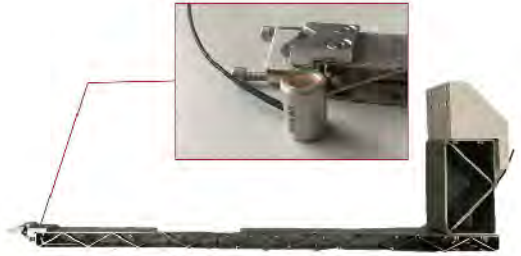
DTS 透射接收探头频率选择范围从 25 - 100 MHz， 焦距 12.7 - 19 mm
