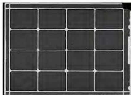
DBC 陶瓷与覆铜 层界面的 C-扫描 图像
