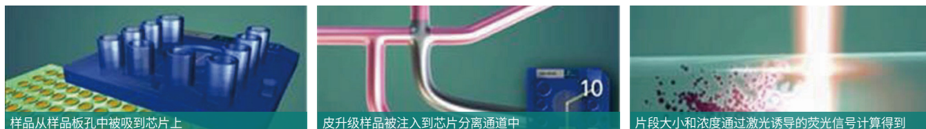
图 8. Labchip 电泳工作原理
