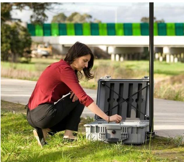
3659型噪声记录仪包含手持式噪声分析仪2250型，配套搭载所需的一切软件和配件，包括完整的统计信息，1/3倍频程分析，带事件触发的音频记录和存储卡，使您能够轻松地进行现场记录。
