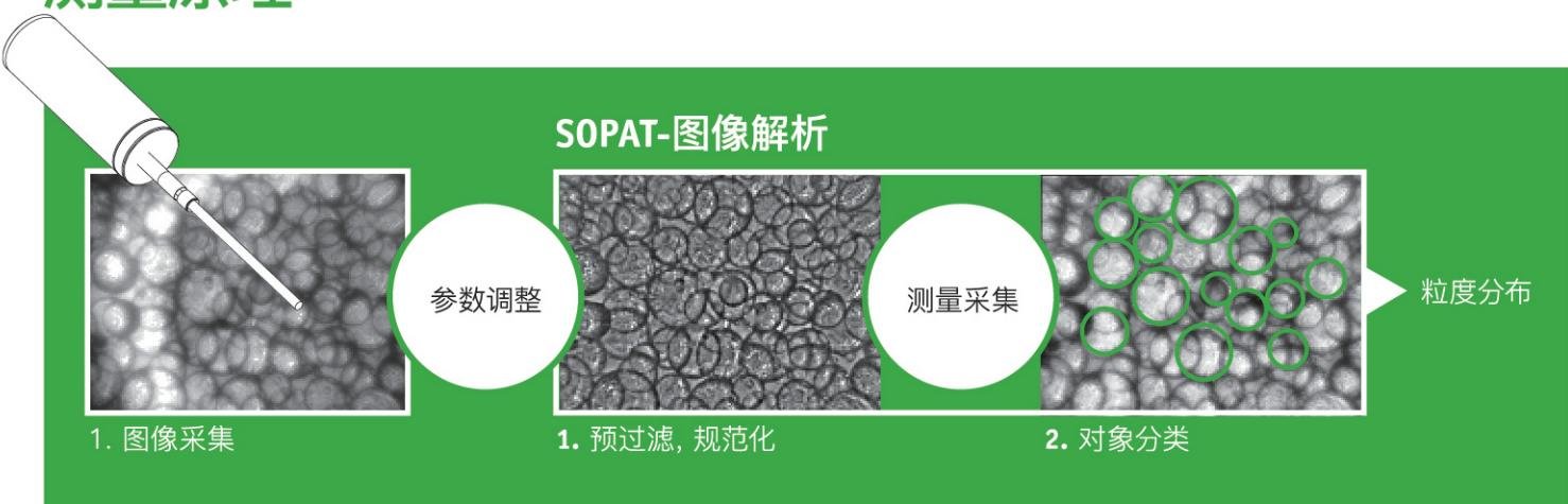
为得到统计学上可靠的粒度分布, 需要对大量的颗粒设定后得到的数据被测定。SOPAT程序首先采集大量的的原始图像数据, 随后识别粒子, 其主要分为三个步骤:
