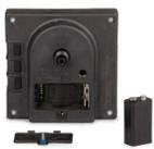
DVR 3pro是一个全电子的、用途广泛的真空规，并且具有ATEX防爆认证(ATEX category 2)，可用于具有潜在爆炸风险的工作区域。该真空表操作简便，大屏图形和数字真空显示，用户可快速趋势判断，读取压力测定值更加简单和精确。DVR 3pro内置的氧化铝陶瓷薄膜电容传感器具有耐化学腐蚀性，准确性高和超长稳定性。一个特别的优点是采用9V碱性电池供电（电池可独立更换），符合条件的电池可从零售店购买。拆下后盖即可更换电池，操作非常简单（注意：更换电池的操作必须在ATEX防爆区域以外）
