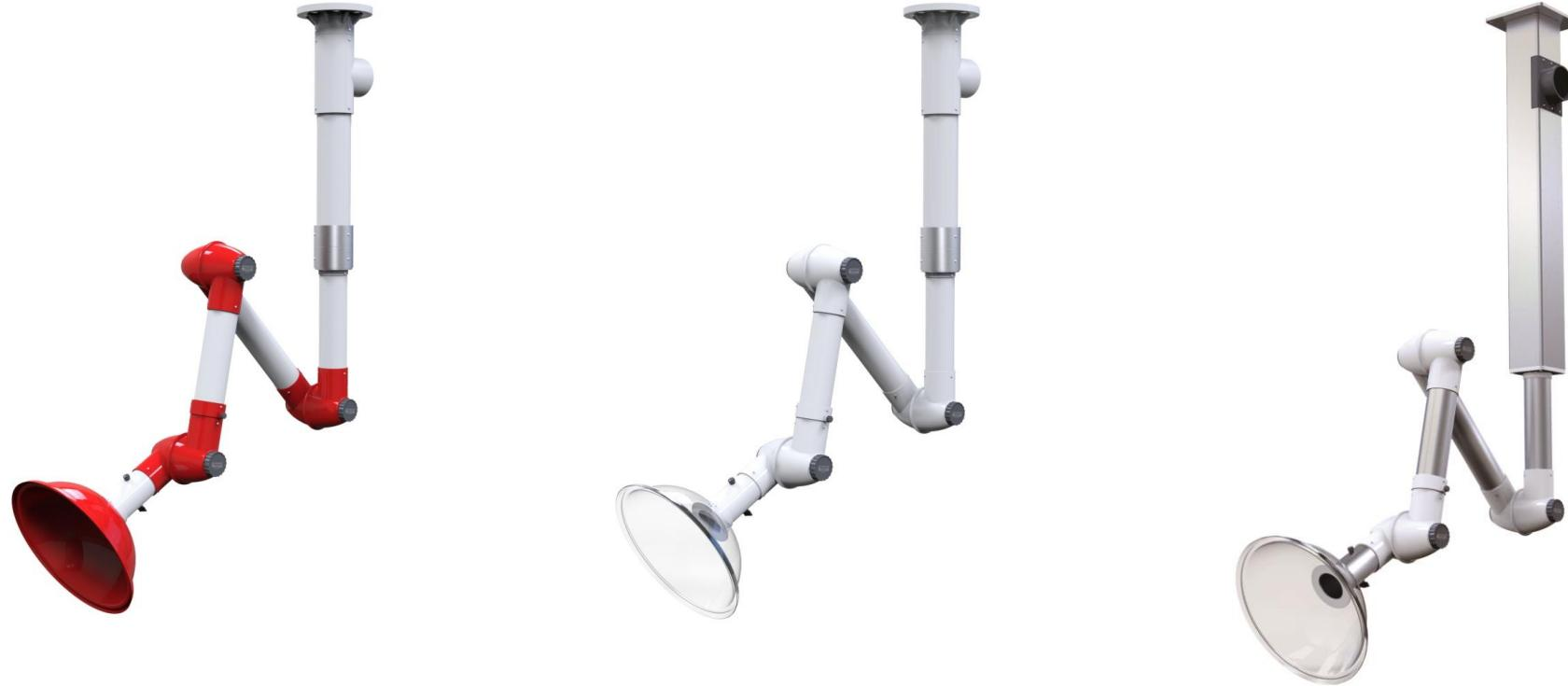
关节：采用高密度 PP 聚丙烯材质，可 360° 旋转调节方向，易拆卸、重组及清洗。关节密封圈：采用不易老化的高密度橡胶。关节连接杆：304 不锈钢连接杆。关节松紧旋钮：高密度 PP 材质，内嵌不锈钢轴承，与关节连接杆锁合。气流调节阀：方便的手动调节外部阀门旋钮，控制进入之气流量。集气罩：PP 白色/红色/透明，PC 全透明大罩。
