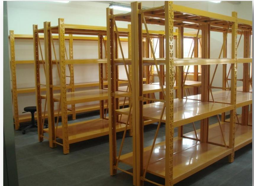
实验室货架钢骨结构为 1.5mm 厚度冷扎薄板，层板采用 1.0mm 厚度冷扎薄板，所有表面经环氧树脂粉末喷涂，非常结实，其表面采用静电粉末处理，防腐、防锈，坚固耐用，横梁采用型材 40\*60 P 型管加工而成实验室专用货架，货架的旁侧竖杆上有很多螺丝眼，可根据实际需要自由调节置货层数和每层之间的高度，外型美观、结构简单、安装拆卸方便、不用任何螺栓，不占空间，款式的可选性能保证完全满足使用的需要。
