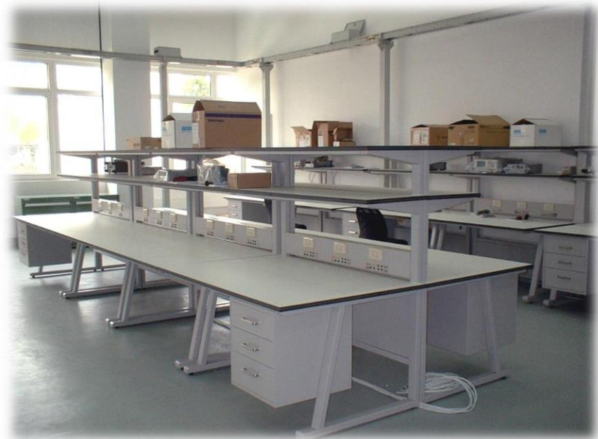
防静电工作台主体采用金属材料，台面采用防静电实芯板、防静电防火板、防静电台垫，良好的接地措施及优异的防静电性能。附件可任意搭配，可根据不同的工作环境，灵活地调整防静电工作台的组合，预留电缆配置盒并具有若干组多功能电源插座，并配置照明系统，使用方便，防静电工作台按照组成来分类，主要由三部分组成防静电台面、工作台支架、附件三部分组成，如果按照使用性能来分类大致可以分成导静电防静电工作台和耗散型防静电工作台两个部分组成。
