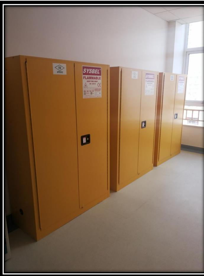
实验室安全柜用于规范储存易燃液体及某些危险化学品，各种不同尺寸的防火安全柜能为可燃、易燃液体及化学品提供安全储存，体积小巧的化学品储存柜，能够摆放在工作场所存放可燃、易燃品及有机溶剂，小型防火安全柜能为可燃、易燃液体及化学品提供安全储存。
