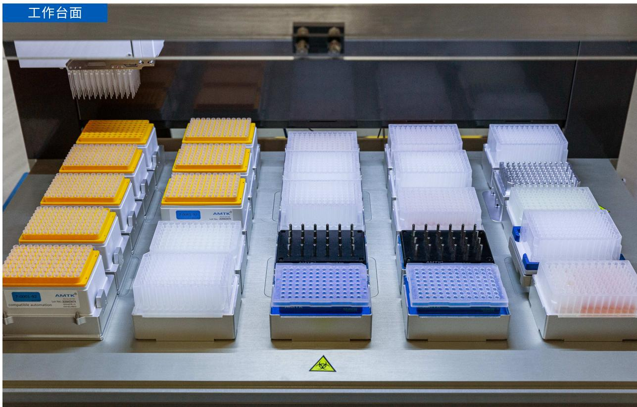
25个标准板位，支持温控模块、振荡模块、磁分离模块的多种组合，位置可随意变动，台面开放，兼容不同品牌或流程的试剂盒；丰富的装载台面设计，可一次满足192个样本的核酸提取或建库纯化等流程；板位数量可实现多个流程的一次台面布局，减少人为更换台面次数，满足客户对自动化程度和通量的多重需求。
