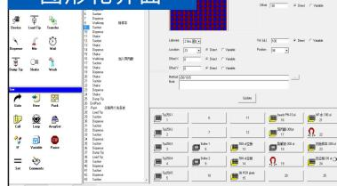
可视化界面，程序运行时显示台面布局；顺序编程，操作简单；独特的断点续接功能，便于实验员处理故障；软件设计语句开放灵活，适配于各种应用场景，并可根据客户特殊需求自定义程序参数。
