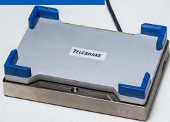
整合进口品牌inheco无磨损磁力振荡系统，振速范围100-2000rpm，可用于96孔板的整板混匀，通量和效率兼可满足，和移液头吹打混匀相比，可降低试剂关键组份或珍贵微量样本在吸头中的损耗。
