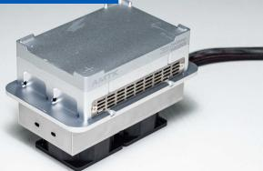
温度范围为4—75°C，满足样本前处理过程中对高温和低温的要求，可用于常规核酸提取的裂解、磁珠洗脱等流程的加热功能，也可用于酶试剂的低温暂存；与铝制加热适配器配合使用，不仅加快升降温速度，而且减小孔间温度偏差。
