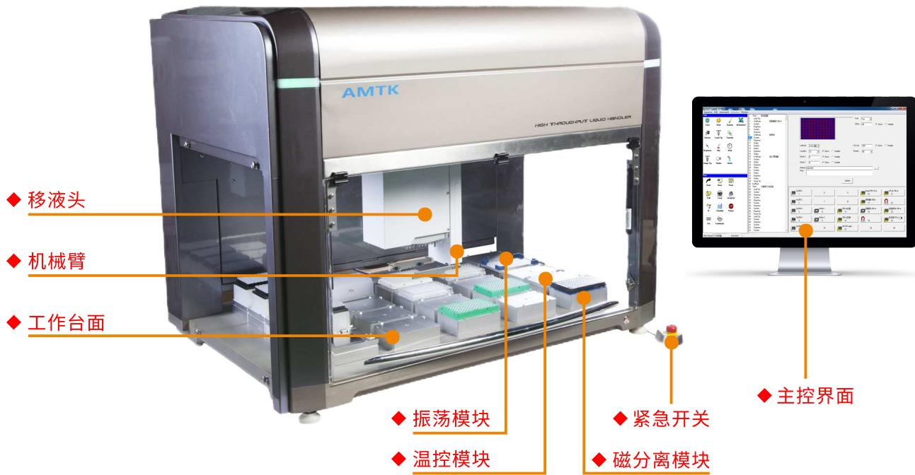
AMTK®LH-1209是一款基于磁珠法核酸提取纯化的全自动液体处理工作站，具有高通量、高精度、高整合性、高性价比、高开放性等特点。系统主要由96通道精密移液模块、磁分离模块、温控模块、振荡模块及软件控制中心构成，可广泛应用于第三方医院检测中心、血站、医院、防疫中心、疾控中心、科研院校等多个领域。
