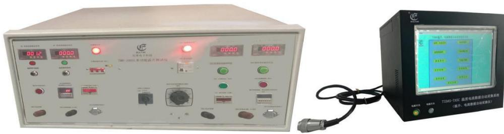
TMR-100SL（交直流一体）多功能温升测试仪为尼普电子科技（上海）有限公司依据 CQC 13140、UL1977、UL1059、UL486、IEC512-3、GB/T12706、GB/T2951、UL1363、VDE 等标准研制的测量连接器、接线端子、插头插座、电源线等电子电气产品智能型温升测试设备。
