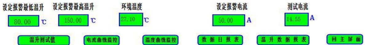
由温度电流变化采集监测界面可看出，报警温升和报警电流可由用户自己设定，极大方便了用户根据不同条件对产品的设定范围。
