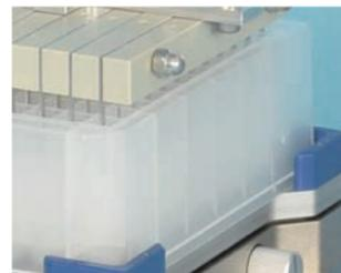
为了去除基质残留物, 在萃取完成后, 将清洗液放入96深孔板中, 将其转移至振荡位上, 将 CBD 短暂 (<30 秒) 浸入水相中 (每孔1-2ml)。
