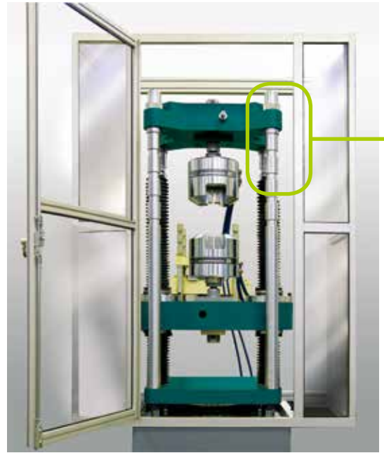
此款600SL机架的立柱有所加高，但可调节横梁上的丝杆为标准长度。立柱带有凹槽，以便调节横梁高度，整个设备带有安全防护罩。
