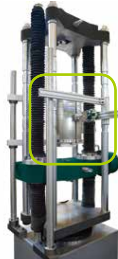
标准600kN(120,000lbf)SL配备闭合式横梁、齿轮式夹具、和加热炉。
