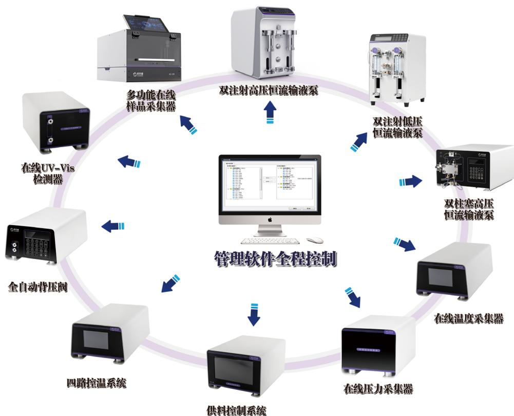
流动化学模块系统流程图
