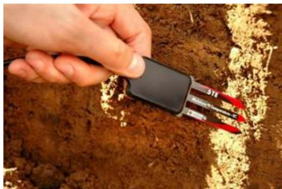
TEROS 12 土壤水分、温度、电导率传感器兼具准确性、经济型、易用性和可靠性。TEROS 12 传感器可连接 METER 的最新数采, 如 ZL6, 可实现传感器的即插即用和数据的云端存储管理。
