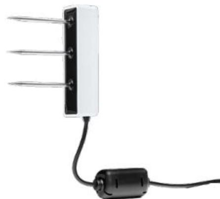
TEROS 21 土壤水势传感器 (原 MPS-6)能购实时、连续、原位监测土壤水分、温度、水势的变化, 是土壤水动力学的基础研究设备。广泛应用于农田蒸散、作物耗水、森林水文、湿地水文、草原生态、水土流失、环境污染、水循环研究等领域。
