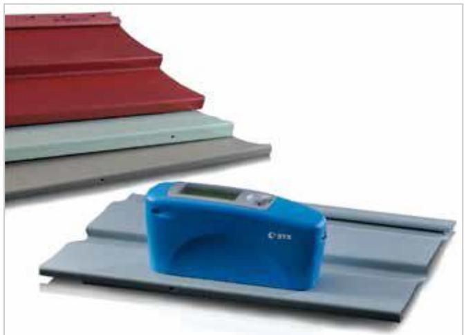
微型光泽仪75°：特别应用在纸张、纸板和表面有结构的塑料，如聚乙烯板材
