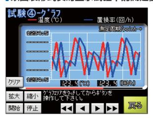
可在触控面板上显示设定好的每个测定周期所更新的试验槽内的温度和空气置换率的图表。可在试验时直接观测到实时的试验槽内的温度和空气置换率。
