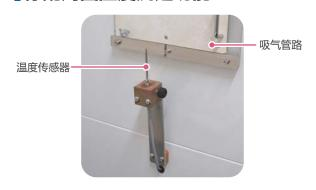
周围温度测定用温度传感器设置在吸气管路附近,会将测定的周围温度计算出空气密度( $\rho$ )并反映在空气置换率计算上。
