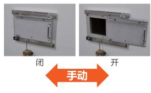
为达到指定的空气置换率,吸排气风挡的开闭度需要边确认触控面板所显示的测定置换率边进行手动调节。
