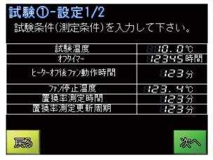
设定试验条件时,可设定加热器的停止时间,避免发生试验超时继续加热现象。
