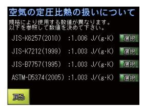
空气的定压比热,标准里所规定的数值已有记录。在触控面板上选择后会自动计算。
