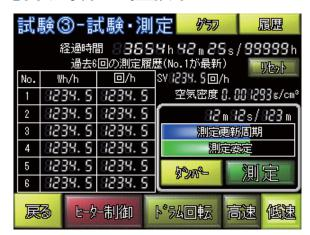
在输入并选择所需条件后,烘箱会按照 P.2 所记载的公式进行自动计算空气置换率并在触控面板上显示。
