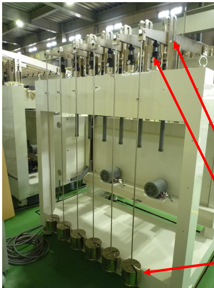
试验片断裂时 吸收掉落冲击力 用缓冲器 及负荷升降装置
