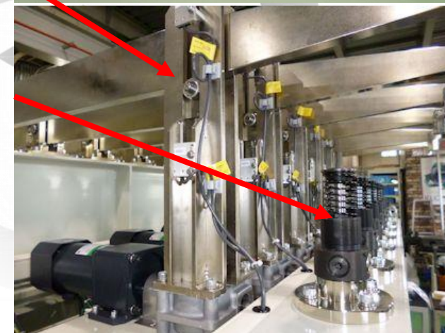
试验片断裂时 吸收掉落冲击力 用缓冲器
