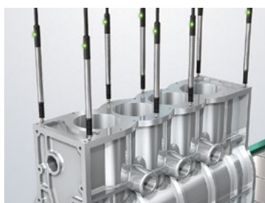
发动机缸体的平面度检测
