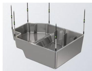
机油盘的平面度检测
