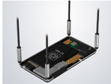
智能手机的外壳平面度检测
