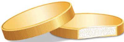
假冒金币的示意图，内部是钨基杂质合金，外层为黄金镀层
