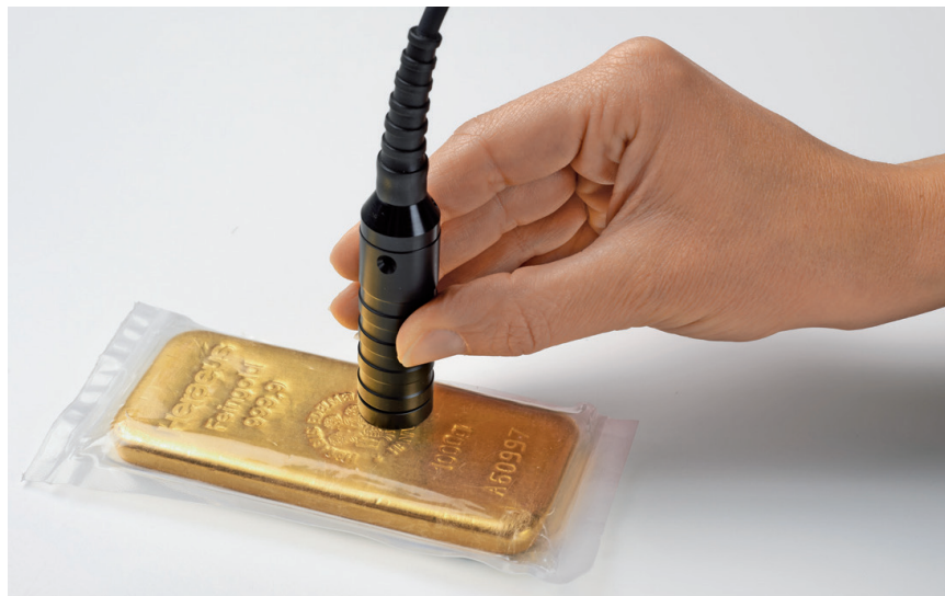
纯金检测——甚至可以隔着保护膜进行测量
