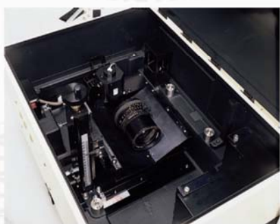
装有相机镜头的MPC-3100内部
