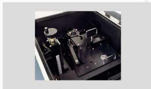
BIS-3100上安装ASR-3112时的状态
