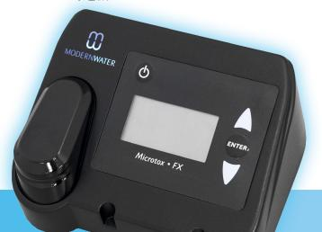
Microtox® FX 可在给水系统或工业废水系统 任何地点采样测试,尤其适用于远离分析设 施的地点,如水库,储水箱,自然水体及任 何难以到达的地方。
