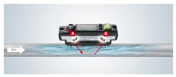
FD-Q 会测量将超声波信号从传感器上的 A 点传输到 B 点所花费的时间(t1)。流速增加时,信号从 A 点传输到 B 点的时间将会缩短,因此信号会加速(t2)。通过流量时间长短和流速的关系,FD-Q 便可对流体进行实时监控。
