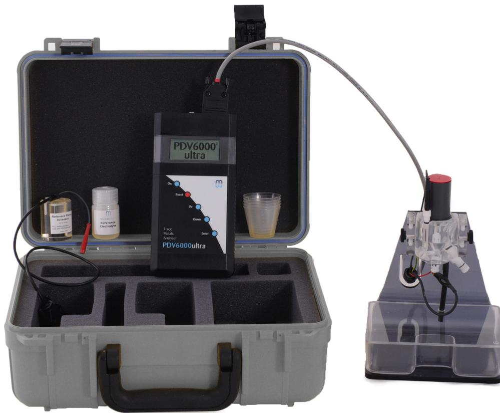
PDV 6000ultra 全面升级了现场单机检测功能，并增加了显示空白和标样结果可靠性的功能。仪器更大的屏幕可直接显示伏安图，USB连接取代了原有的串口。PDV6000ultra 可由四节1.5伏AA 电池供电，也可由标准的8-12伏直流电源供电。
