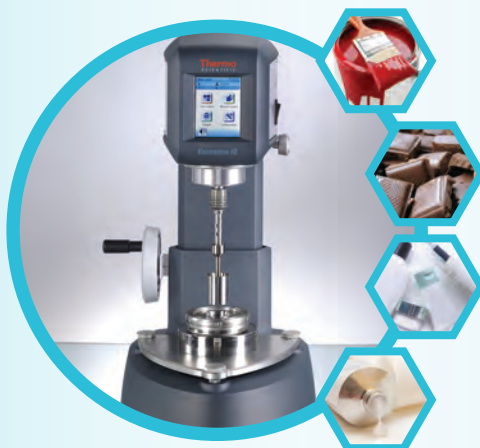
小尺寸同轴圆筒， 内径32 mm
