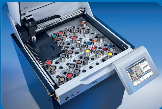
适用于重样品和带有高清摄像头的高清 XRF 2 面扫描的 60 位样品杯进样器
