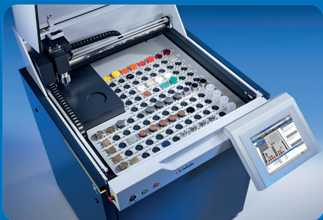
108 位进样器, 用真空吸盘直接抓样 (压片和熔融玻璃片)
