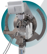
掠入射 X 射线小角散射, 用于表面纳米结构表征
