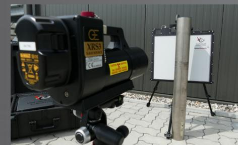
移动式X射线设备可以安装在三脚架，皮带安装架，维可牢尼龙搭扣带和其他配件上，以确保在每种情况下都能安全，轻松地获取图像。远程WiFi可以从安全距离进行远程曝光。易于处理，可确保在几秒钟内完成设置。
