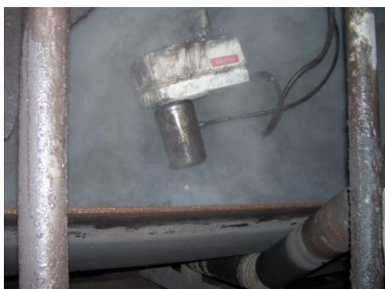
图 5 安装在现场的红外水分仪测量探头
