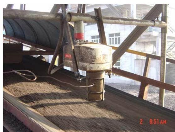
图 4 安装在现场的红外水分仪测量探头
