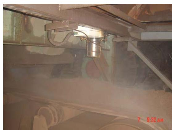
图 6 安装在现场的红外水分仪测量探头
