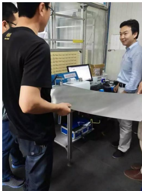
图7. GNR直读光谱仪现场检测大钢板
