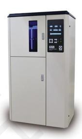
**氙灯老化箱**采用能极大吻合性地模拟自然界全阳光光谱的氙弧灯来再现不同环境下存在的破坏性光波,再现了全光谱太阳光和雨水所带来的破坏,从而可以极好的对材料进行耐光性与耐候性加速试验,再现材料发生在几个月或几年的户外破坏。可用于新材料的筛选、改进现有材料或评估材料成份变化后耐用性的变化等试验。
