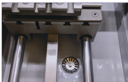
切割室环氧树脂防腐涂层
