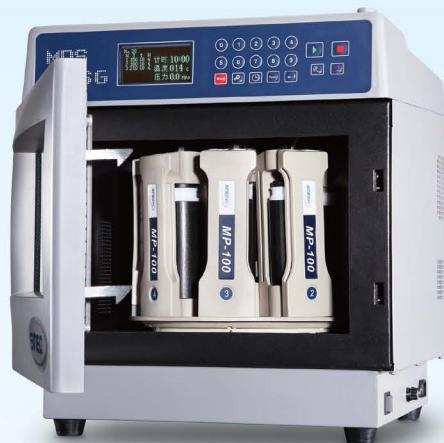
一台主机可实现多种功能，微波消解、微波萃取及微波合成功能可灵活切换
