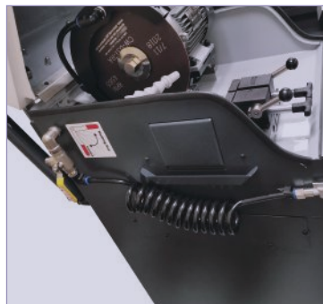
3个冷却液喷嘴和1个清洗喷嘴
