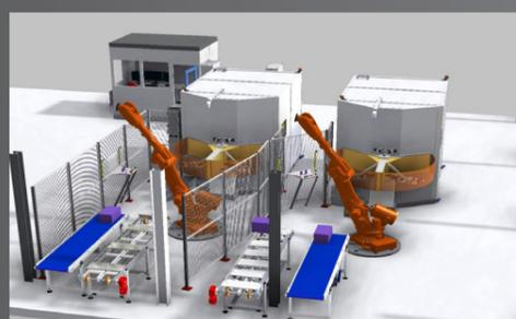
如果产量极高，则可以通过将系统分组到检查集群来轻松扩展检查产能。相连的系统可以连接到相同的输送机并进行通讯以使效率最大化。
