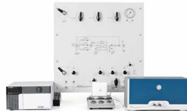
高压石英晶体微天平由高温样品台、高压流动池、高压泵、液体处理单元和电子单元组成
