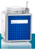
根据国际标准，TOC必须在  $> 680^{\circ}\text{C}$ 的温度下进行氧化。 $680^{\circ}\text{C}$ 至 $750^{\circ}\text{C}$ 是高盐负荷样品燃烧的理想温度范围。此外，高达 $1200^{\circ}\text{C}$ 的温度确保最佳的氧化条件和良好的回收率，即使是高度稳定的化合物，如腐殖酸或富里酸或含有颗粒的样品。enviro TOC 坚固耐用的燃烧炉具有灵活可调的温度范围，涵盖所有这些要求，确保完全氧化。
