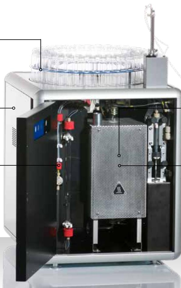
④ 燃烧管配备独特的SALTRAP技术，确保燃烧管使用寿命更长与运行成本更低
